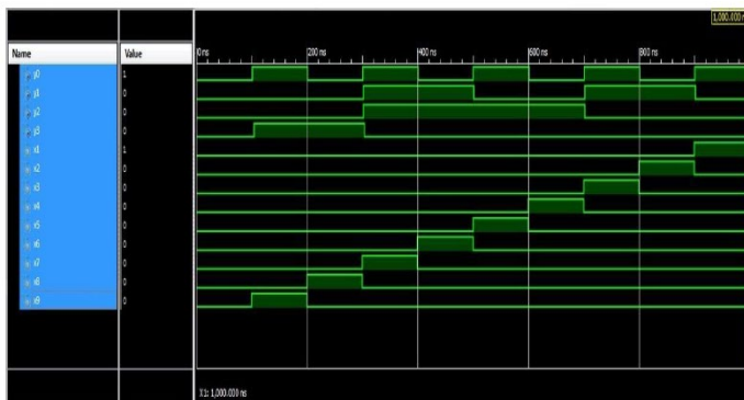
Рисунок 3 – Временная диаграмма шифратора в программной среде XILINX
